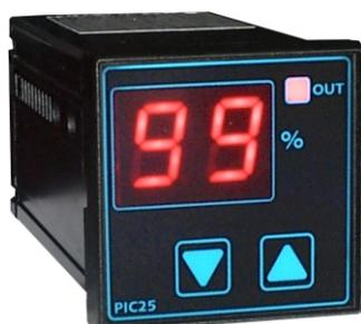
Strumento adatto a comandare dei relè statici. La percentuale impostata viene convertita in impulsi a tempi proporzionali programmabili o uscita analogica 0-10V. Possibilità di impostare il limite minimo e massimo di potenza attivati per tutta la scala 0-100%.
